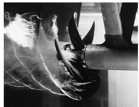
prestaciones. La cavitación puede estropear fácilmente una hélice, mellando sus bordes de ataque, doblando las palas o picando su superficie.
