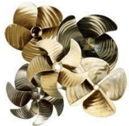
Las hélices convierten la energía rotacional generada por el motor en el empuje necesario para el desplazamiento de un barco. Descontando el diseño de esta, cuanto más grande sea más eficientemente trabajará. El problema radica en conseguir un equilibrio entre este tamaño y la capacidad del motor para hacerla rotar a su régimen de trabajo idóneo.
